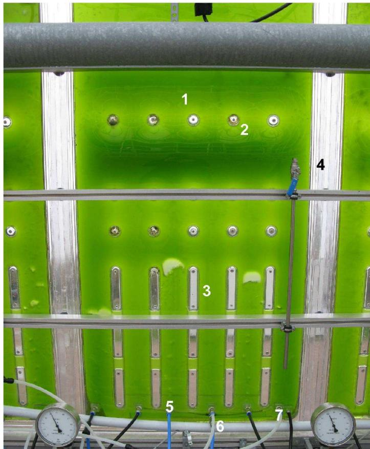
**Abbildung 5:** Rückansicht eines Bioreaktors – der Bioreaktor besteht aus zwei tiefgezogenen PET-Kunststoffschalen (100% recyclebar), die einen ca. 2cm breiten Hohlraum einschließen, durch das das Medium mit den Algen zirkuliert (Abbildung : ©SSC GmbH)
